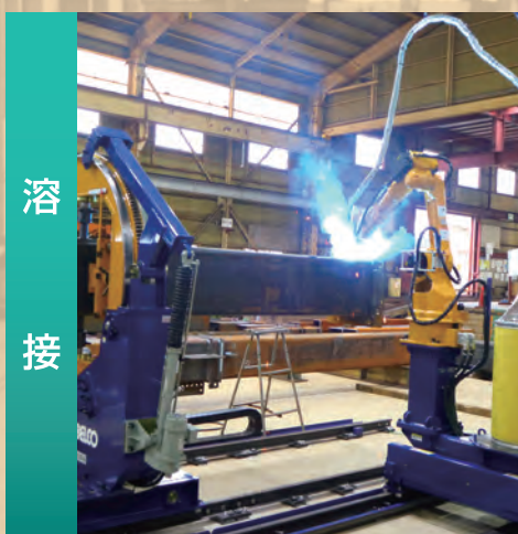
■溶接 ロボットや人の手によって溶接を行う
