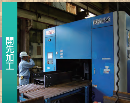
■開先加工 溶接しやすいよう鋼材の角や面を切断する
