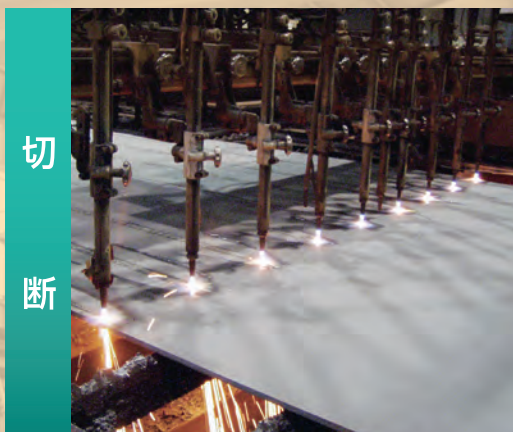
■大型自動ガス切断機 寸法を設定し、精巧に切断される
