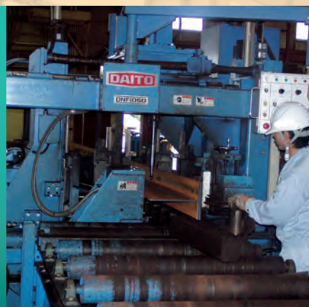
■ NC多軸ボール盤 所定の位置に孔をあける
